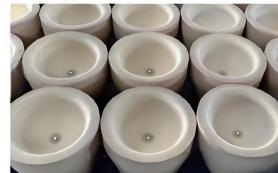
灰皿是火试金 (Fire Assay) 工艺中用于金银分离、吸收铅液的重要耐火材料制品。其主要功能是在高温氧化条件下吸收熔融铅及其氧化物 (PbO)，从而将金、银等贵金属富集于灰皿表面，实现后续称量或成色分析。灰皿通常与火试金粘土坩埚配合使用，是贵金属分析实验中不可或缺的核心耗材。
