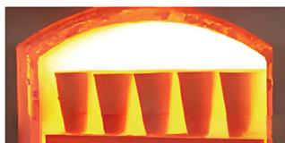
火试金粘土坩埚是一类专用于火法试金 (Fire Assay) 工艺的高温耐火陶瓷容器，主要用于贵金属（如金、银、铂族金属）在高温熔融、氧化、还原等过程中进行分离、收集及测定。该类坩埚具有优良的耐火性、抗热震性和化学稳定性，可在多次热循环条件下保持结构完整性。
